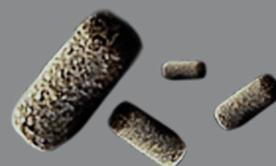
Para estudiar la uniformidad del producto en términos de longitud de corte, se midieron cien unidades de alimento 3 y 5mm peletizados y extruidos, mediante el uso de un calibrador vernier digital. Posteriormente, los valores se ordenaron en intervalos de frecuencia para observar qué dispersión se observa entre los datos alrededor del valor nominal. Los resultados se presentan en las figuras 4 y 5.
