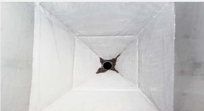
Al final de la prueba se observó que en promedio el tiempo de descarga del alimento de 3mm extruido es 1,40 segundos y para peletizado 2,10 segundos. El patrón de flujo y los tiempos de vaciado se muestran en Fig. 3.
