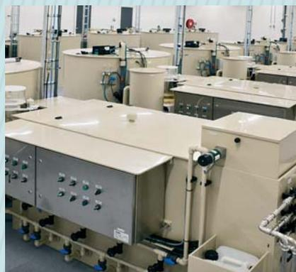
Установки замкнутого водоснабжения (УЗВ)
